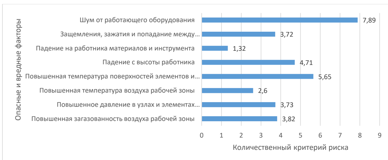
Рисунок 3. Количественный критерий риска при монтаже и испытании технологического оборудования (расчет для комбинированной установки переработки нефти)
